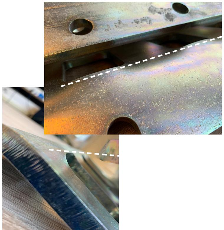
Abbildung 1: Die Verformung, die nach dem Biegen des Produkts auftritt.
